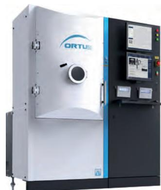
Установка для нанесения оптических покрытий в вакууме методом электронно-лучевого и резистивного испарения с предварительной ионной очисткой и ионным ассистированием в процессе напыления
