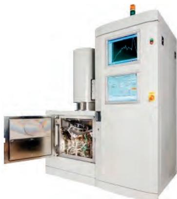
Установка для нанесения односторонних тонкопленочных покрытий методом магнетронного напыления с предварительной ионной очисткой
