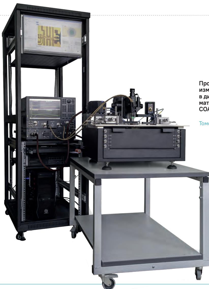
Программно-аппаратный комплекс для измерения параметров МИС на пластине в диапазоне до 110 ГГц на базе полуавтоматической зондовой станции Terra-200 SOAX производства АО НИИПП.
