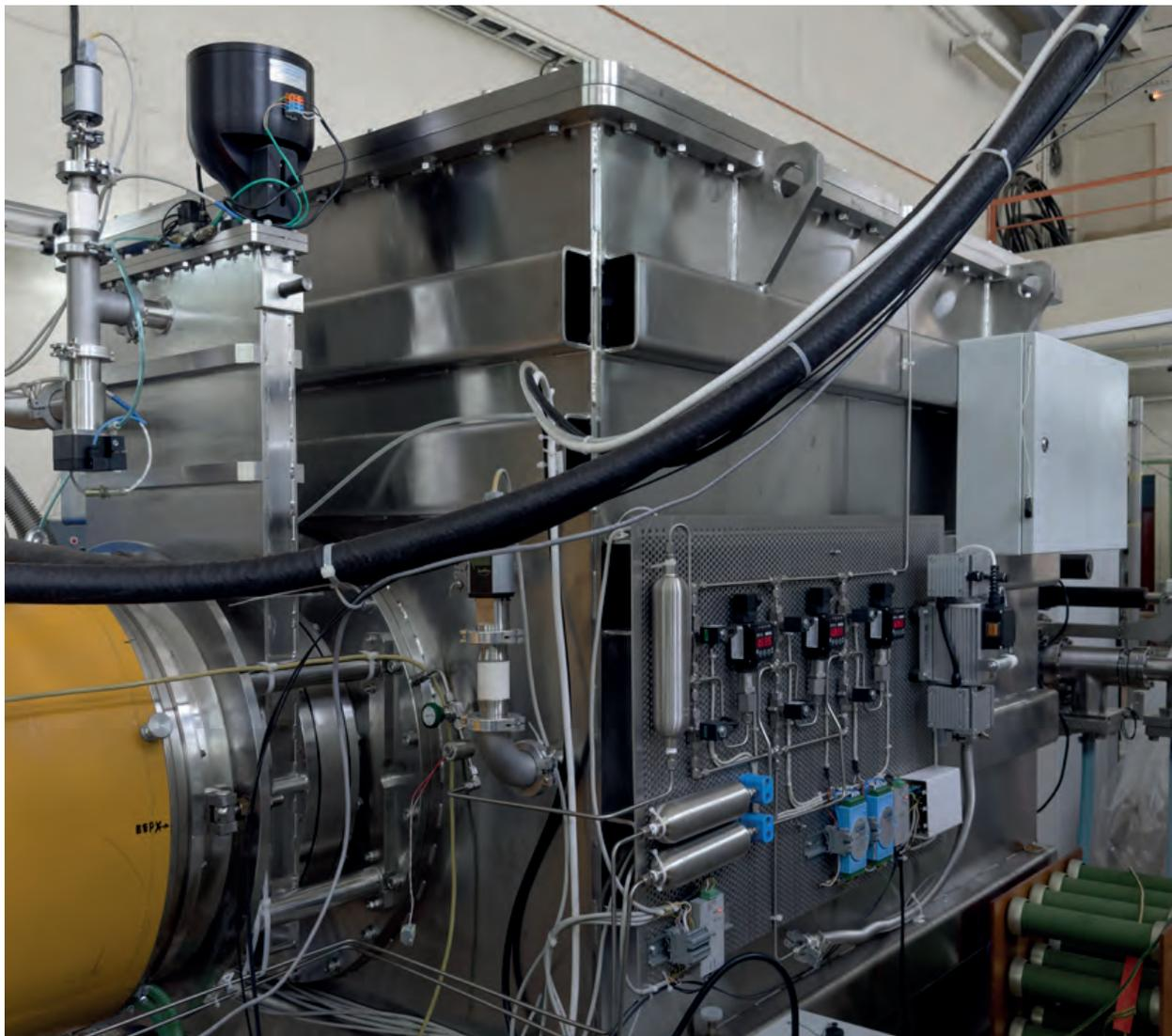
**Изготовление и поставка вакуумной камеры ускорителя с шероховатостью всех поверхностей 2G/2R, отожженной и обезгаженной при температуре 400°C и вакууме 10-5 мм.рт.ст., в течение 24 часов**
