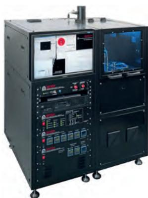
Установка плазмохимического осаждения (PECVD) для роста графена и углеродных нанотрубок, VM Pro, Aixtron
