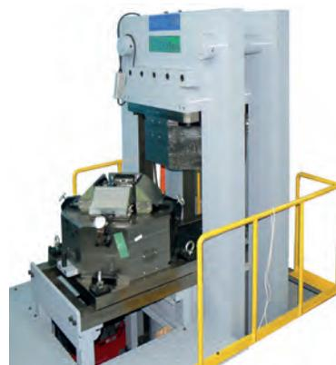
Установка генерирования давления и температуры Discoverer для изучения синтеза алмазов и материалов, расположенных внутри Земли на глубине 1000 км для ИГМ СО РАН
