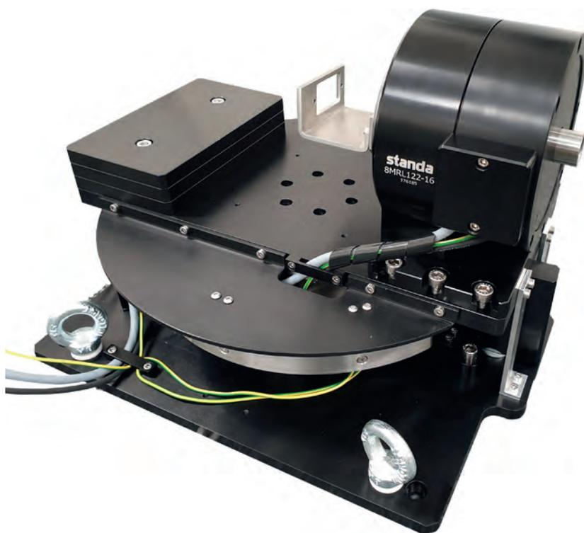
**Разработка 6-осевого моторизированного гониометра для системы детекторов в прототипе искусственного спутника Земли**
